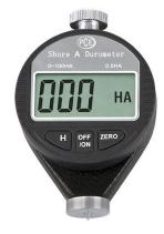
Les mesures de dureté effectuées par HANNECARD sont réalisées selon la norme ISO 6123/1 – 1982.
