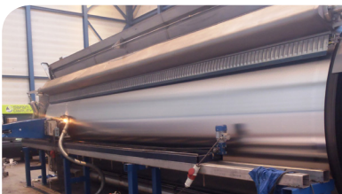
Naprawy szlifierskie w celu likwidacji prolemów zarówno z powierzchnią, jak i kształtem. Poprawia to wydajność suszenia, redukuje pęknięcia wstęgi papieru, poprawia profil CD, wydłuża żywotność filcu i ułatwia oczyszczanie (do 0,15 mm/Ø)
