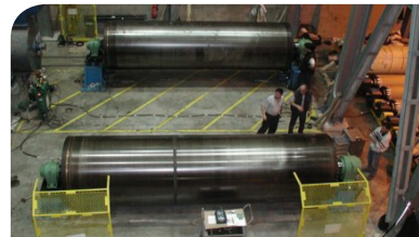
Wyważanie może być wykonywane na miejscu, bez konieczności usuwania części lub w pomieszczeniach klienta po ich usunięciu. Oszczędza to ogromnie dużo czasu i kosztów, które w przeciwnym razie zostałyby poniesione w wyniku przestoju.
