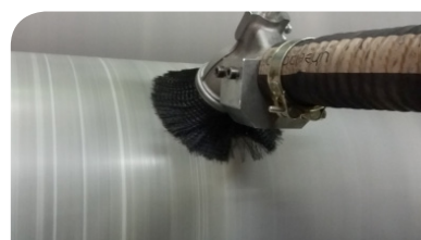
Regeneracja powierzchni jest niezbędna w celu uzyskania odpowiedniej chropowatości powierzchni
